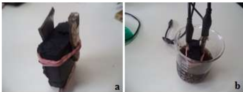
Figura 1: Fotos do experimento a) conjunto construído pra montagem de cada uma das pilhas; b) célula eletroquímica produzida.
